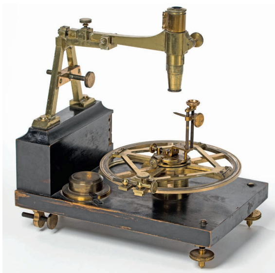
Abb. 6: Horizontales Reflexionsgoniometer der Firma Breithaupt mit von Studer angeregten Verbesserungen, Kassel, um 1830. © TU Bergakademie Freiberg/M. Schwan (aus: Zaun 2015).
