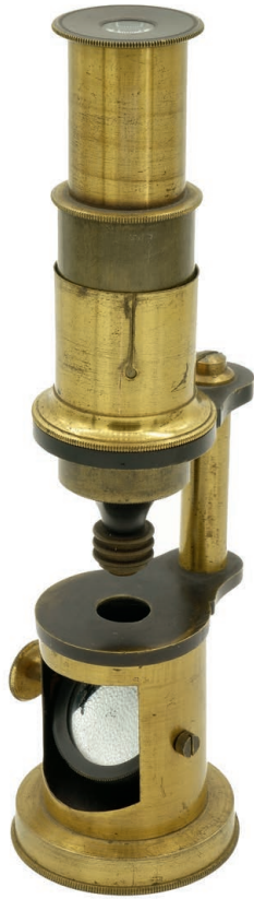
Abb. 4: Mikroskop mit Trommelstativ und Satzobjektiv, ohne Nr., Hersteller unbekannt, zweites Viertel 19. Jahrhundert, Museum für Naturkunde Berlin, Sammlung historischer wissenschaftlicher Instrumente, Inv.-Nr. o/014, Foto: Autor.
