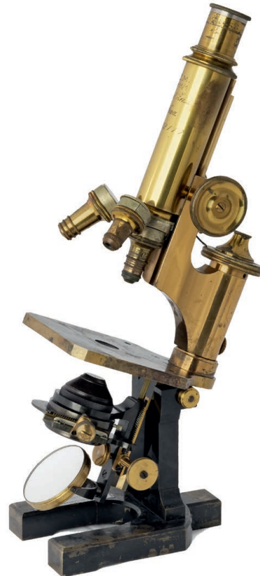
Abb. 4: Mikroskop mit Trommelstativ und Satzobjektiv, ohne Nr., Hersteller unbekannt, zweites Viertel 19. Jahrhundert, Museum für Naturkunde Berlin, Sammlung historischer wissenschaftlicher Instrumente, Inv.-Nr. o/014, Foto: Autor.
