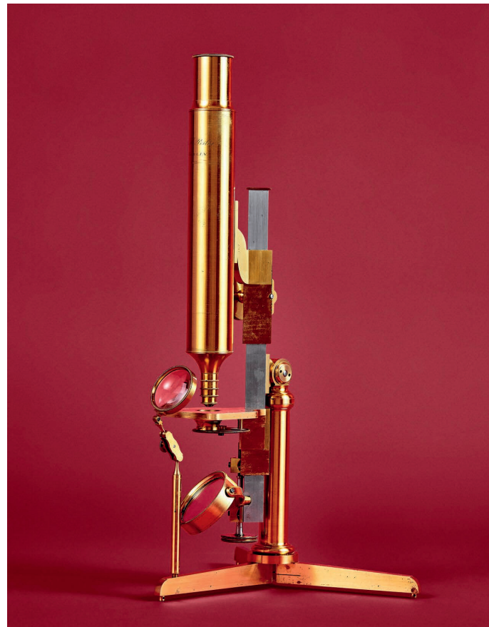
Stangenmikroskop aus der Werkstatt von Pistor und Schiek. Rod microscope from the workshop of Pistor and Schiek. Sammlung Helmut Kettenmann. Max-Delbrück-Centrum für Molekulare Medizin
