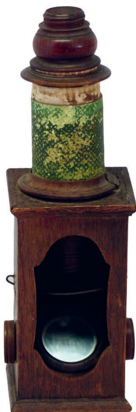
Abb. 6: Sogenanntes Nürnberger Mikroskop; hier das Modell mit dem Kastenstativ. Das Mikroskop stammt aus dem Besitz Ehrenbergs, Ehrenbergsammlung Museum Barockschloss Delitzsch, Foto: Jürgen Geisler, Museum Barockschloss Delitzsch.
